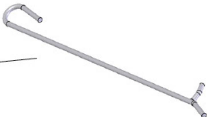
Pour contrôler visuellement la flamme du brûleur pilote, retirez la plaque centrale à l'aide du crochet prévu à cet effet.
